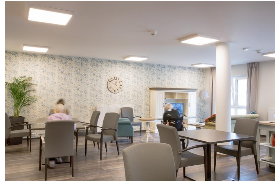
GEMEINSCHAFTSRAUM Panel mit verstellbarer Farbtemperatur im Bereich 3.000-6.000K
